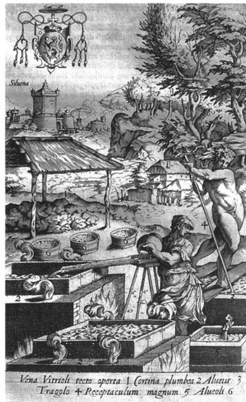
Die europäische Dimension der historischen Sulfat- und Schwefelsäureproduktion: an zahllosen Stellen in Europa, so auch in Selvena in der südlichen Toskana wurden seit dem Mittelalter Vitriol und Alaun in einfachen Lauge- und Sudanlagen hergestellt. Im Hintergrund liegt Gestein unter einem Dach im Freien, um langsam zu verwittern. Vorne ist das Sieden von Vitriol in bleiernen Pfannen dargestellt. (aus: Michele Mercati: Metallothea Vaticana, Rom 1717)
