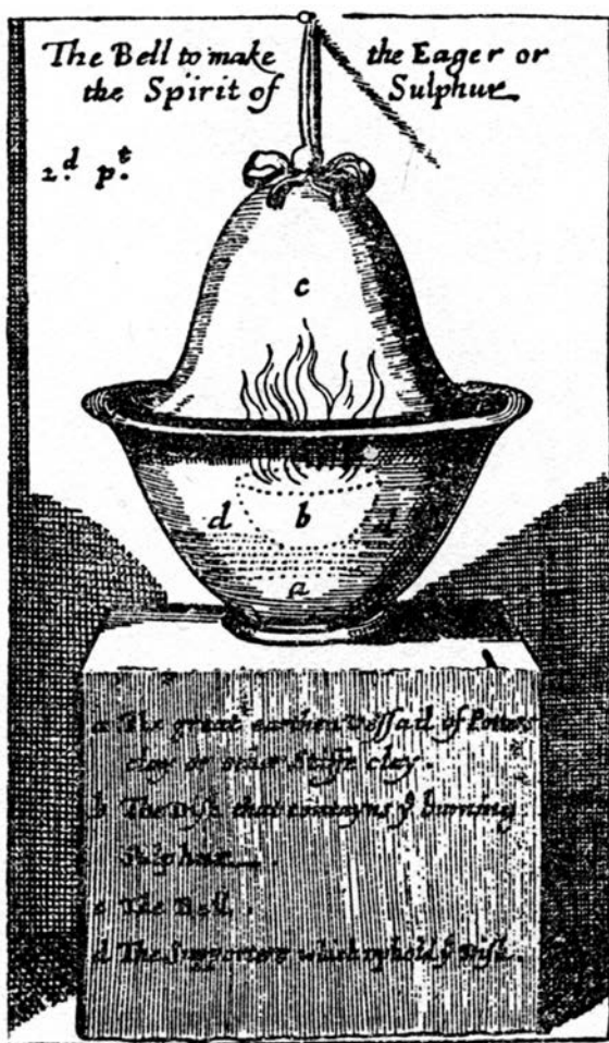
Abb. 22: Reaktionsgefäß mit einem Sockel aus keramischen Material und einer Glasglocke („bell“) zur Herstellung von Schwefelsäure. Das gezeigte Gefäß ist allerdings wohl deutlich kleiner als die Gefäße von Joshua Ward und John White.
