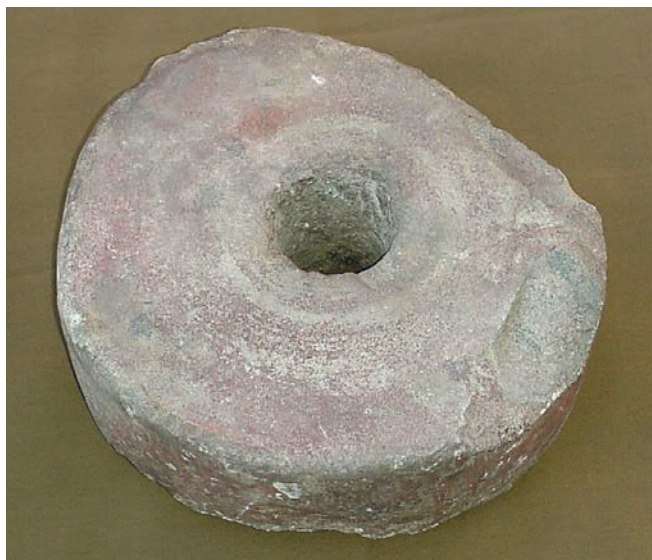
Abb. 36: Mühlstein zur Verarbeitung des beim Vitriolölbrennens anfallenden Caput mortuums. Der Stein wurde bei einer ersten Begehung des Geländes der Vitriolöhlütte am Wegesrand unter einem Baum gefunden. Durchmesser: ca. 40 cm; Höhe: ca. 15 cm.
