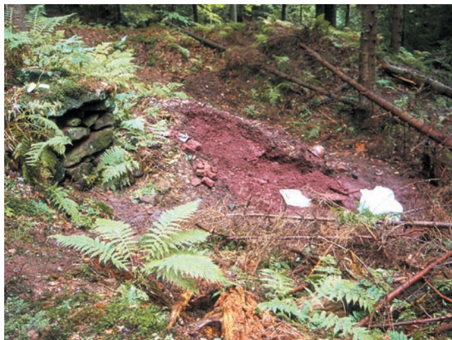
Abb. 35: Intensiv rot gefärbte Halde aufgrund des hohen Gehalts an Eisenoxid (Caput mortuum) als Reststoff der Vitriolölproduktion.
